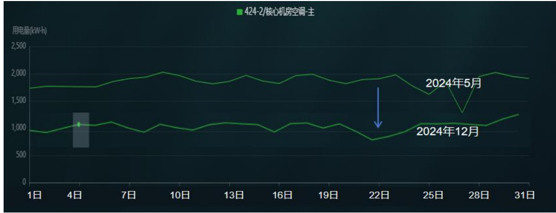
图：机房节能改造用电量前后对比
